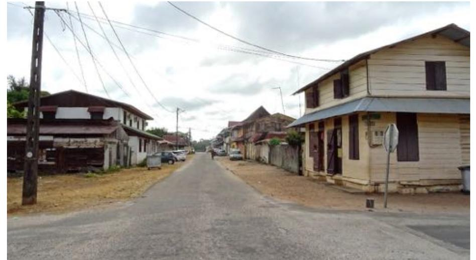
*Rue Javouhey au niveau de la rue Amaranthe Golitin d'une largeur de 13,20 m avec sa bande de roulement centrale en enrobé et ses accotements en terre sableuse qui absorbent l'eau de ruissellement.*
