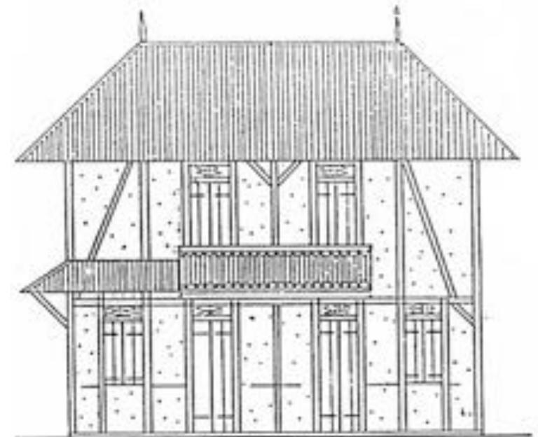
Exemple de plan type d'une maison créole avec toiture à 4 pans, balcon et auvent au rez-de-chaussée.
