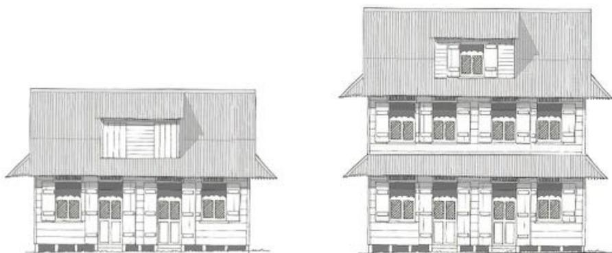
Exemple de construction d'un niveau surmontée d'une surélévation
