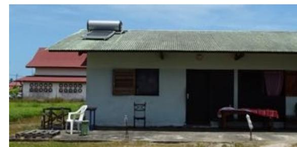
Exemple de ballons de chauffe-eau solaire interdits
