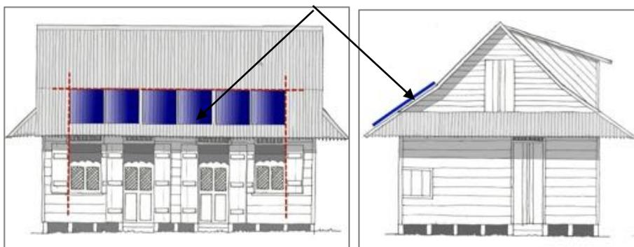
Sur une façade non visible de la rue, exemple de panneaux solaires implantés sur le pan inférieur d'un pan de toiture et axés sur les baies du rez-de-chaussée .
