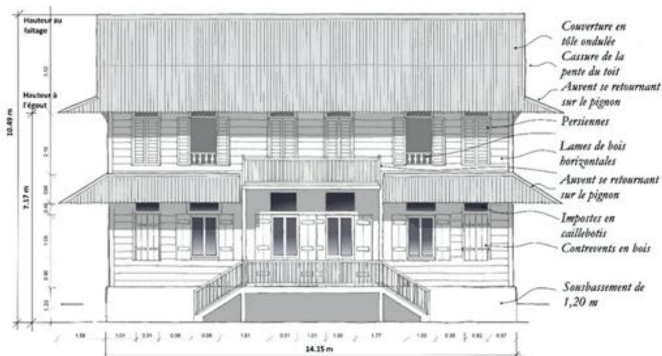
(3) Exemple de façade ayant les caractéristiques architecturales de la typologie maison créole avec une surélévation du plancher du rez-de-chaussée de 1,20 m par rapport au sol naturel pour être conforme aux dispositions du PPRI
